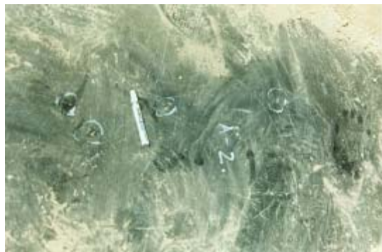
Fig. 17 Perforaciones causadas por cortes de piedras
