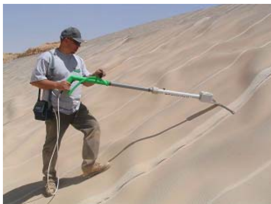
Fig. 19 El verificador de fugas en acción, sobre geomembranas descubiertas
