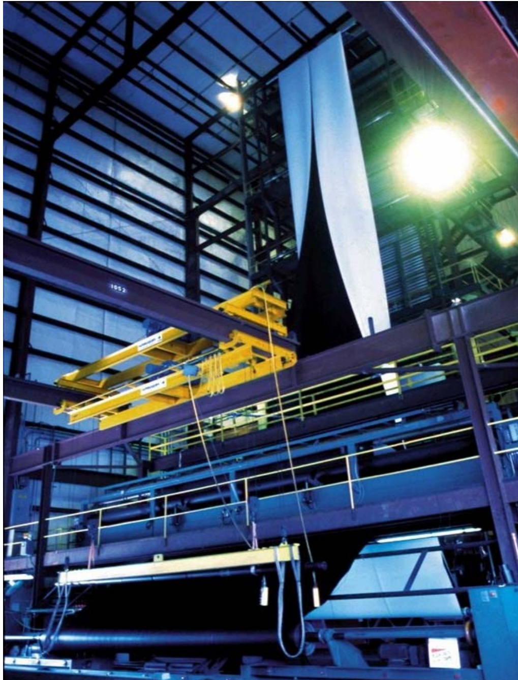
Fig. 4 Conjunto de extrusión con boquilla circular y torre de enfriamiento mediante aire soplado
