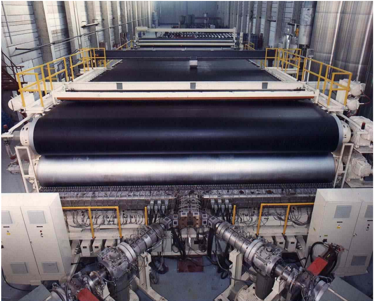
Fig. 3 Conjunto de extrusión con boquilla plana y rodillos de calandrado.
